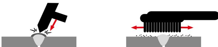
Utilizza una martellina per scalpellare il rivestimento dell'elettrodo depositato sul pezzo e una spazzola per rifinire la pulizia.
