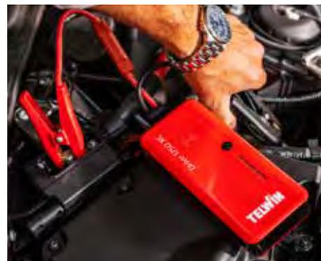
**3** Localisez la batterie et connectez d'abord la **pinces rouge (+)** à la borne positive, puis la pince noire (-) au châssis ou à la borne négative de la batterie.
